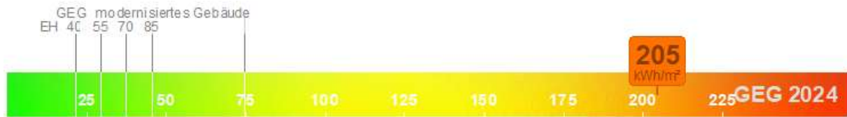
Abbildung 14 | Primärenergiebedarf des betrachteten MFH nach DIN V 18599
