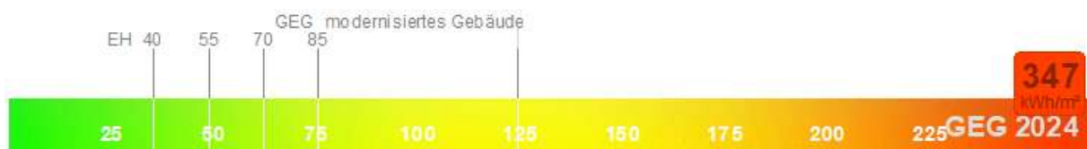
Abbildung 17 | Primärenergiebedarf des betrachteten EFH nach DIN V 18599
