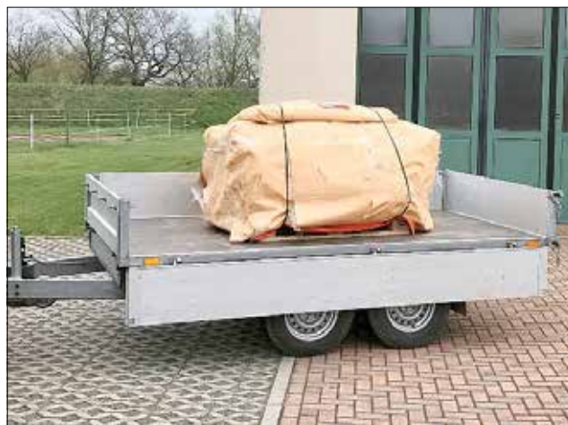
Eingepackter mobiler Löschwasserbehälter, Foto: privat
